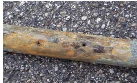
Bei einem kaputten Rohr, so wie am Bild, kann man mit Wasserverlusten von ca. 12.000 Liter täglich rechnen.
